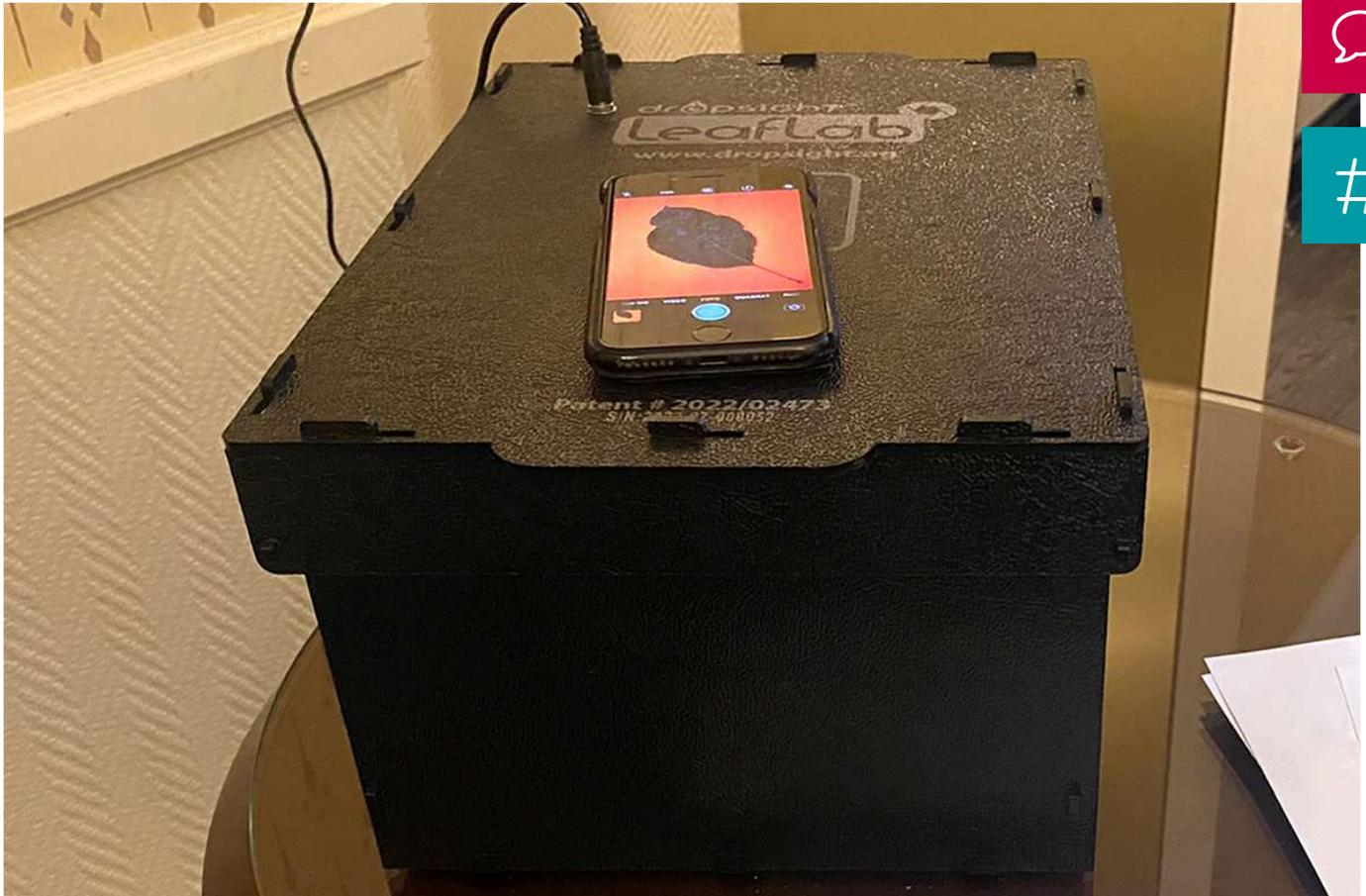
Das sogenannte LeafLab ist eine Kiste mit der Grundfläche eines Papiers im Format DIN A4. Im Deckel der Kiste ist ein Ring von UV-LED's angebracht. Nachdem die Blätter auf den Boden der Kiste gelegt werden, schliesst man den Deckel und fotografiert das Blatt in der Kiste mit dem Smartphone. (Foto: D. Szalatnay, Strickhof)
