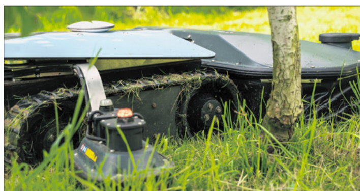
Auf dem Obstbaubetrieb in Güttingen wurde der selbstfahrende Mulchroboter Scarabaeus erfolgreich getestet. (Bild Brüggli Industries)
