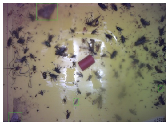
Foto einer automatischen Falle. Die Schädlingserkennung ist noch nicht zufriedenstellend.
