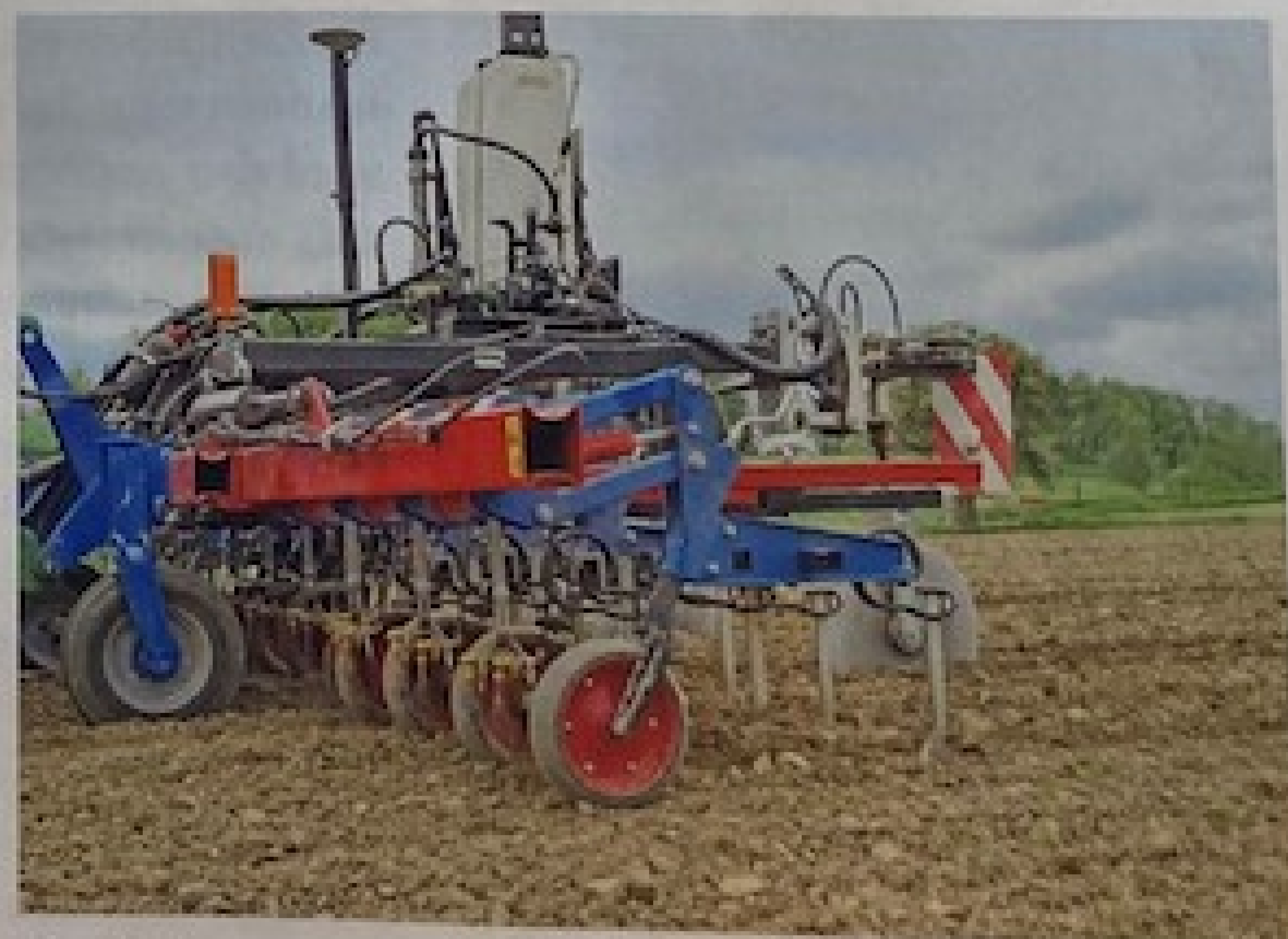
Das Hackgerät ist GPS gelenkt und folgt der Spur, welche die Sämaschine gelegt hat, mit einer Abweichung von +/- 2 cm.
