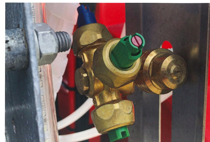
Abb. 2: Wanner-Projektspritze Düsenhalter 3-FACH.
