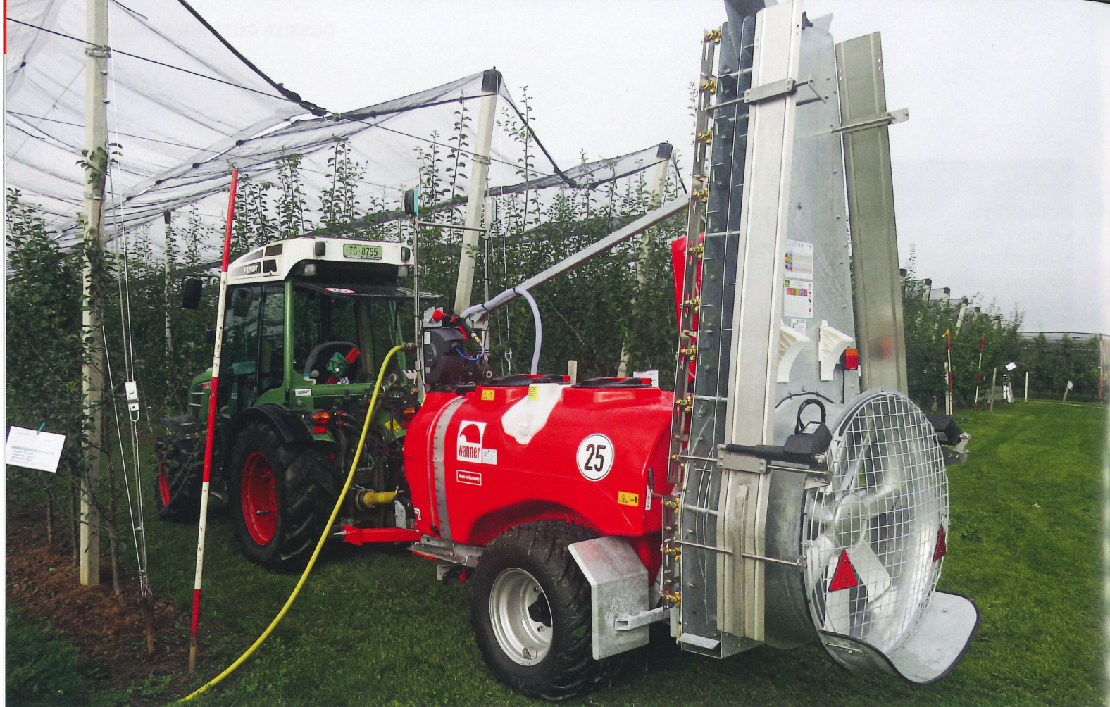
Abb. 2: Wanner-Projektspritze Düsenhalter 3-FACH.
