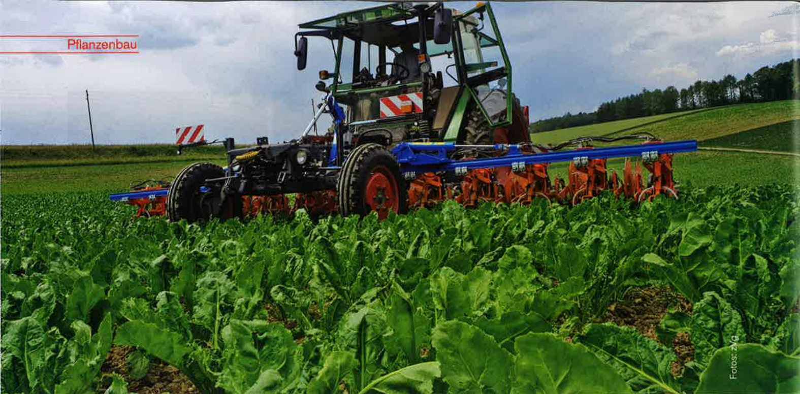
△ Mit dem präzisen, kameragesteuerten Hackgerät mit hydraulischem Verschieberahmen kann der Landwirt sehr nahe an der Reihe hacken.
