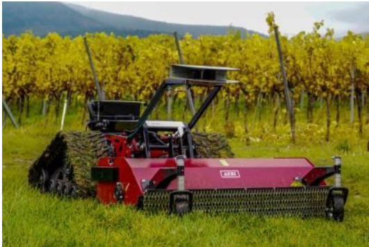
PFLOPF-Massnahme 6: Autonome Mulchgeräte im Obst- und Weinbau senken den Arbeitszeitaufwand für die mechanische Beikrautkontrolle und sind eine Alternative zum Einsatz von Herbiziden. Bildquelle: RobotMakers
