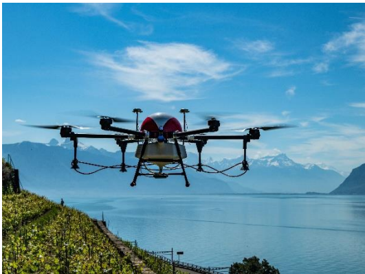
PFLOPF-Massnahme 7: Drohnen zur Pflanzenschutzausbringung vereinfachen in Steillagen die Applikation zum optimalen Behandlungszeitpunkt bei gleichzeitig reduzierter Abdrift. Bildquelle: Sebasti3n R3ttimann
