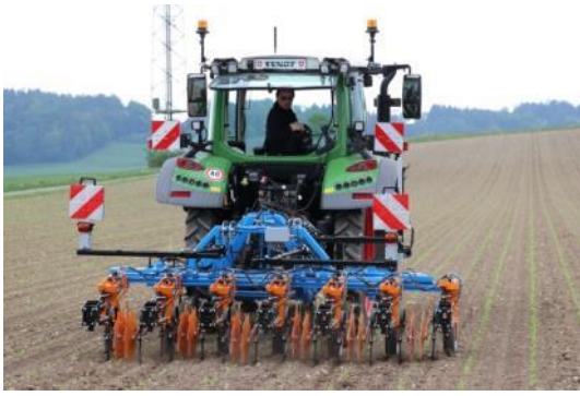
PFLOPF-Massnahme 5: Sensorgesteuerte Hackgeräte in Reihenkulturen haben eine hohe Arbeitsleistung und sind eine Alternative zum Einsatz von Herbiziden. Bildquelle: BBZ Arenenberg
